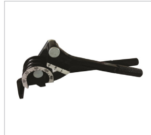
Bakır Boru Kıvrırma
